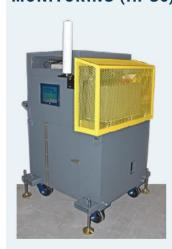
STACK GAS MONITORING WITH HPGe SYSTEM
